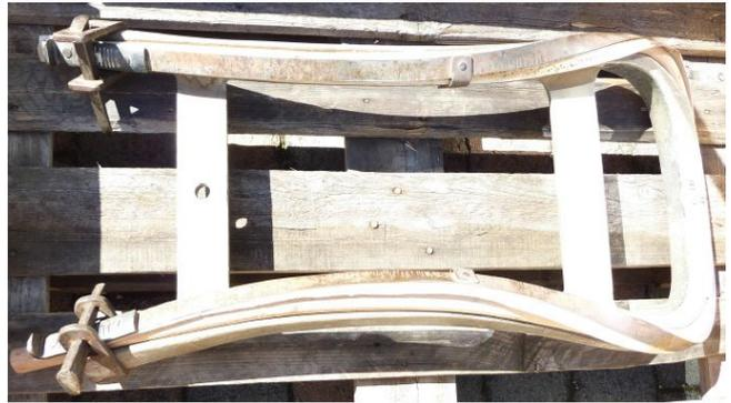
Abb. 6 Dokumentation des Biegeprozesses der Rückenlehne.
