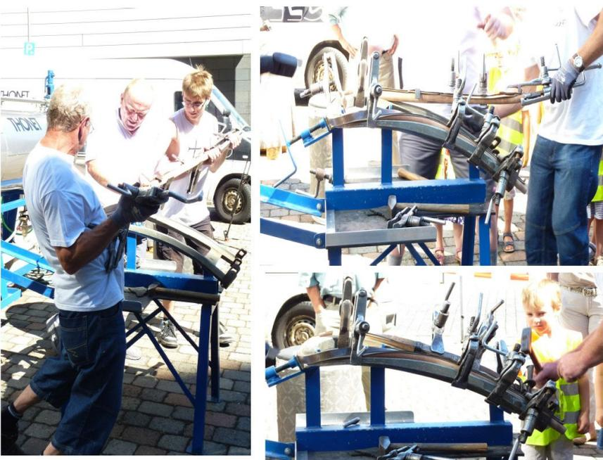
Abb. 5 Dokumentation des Biegeprozesses der Rückenlehne.
